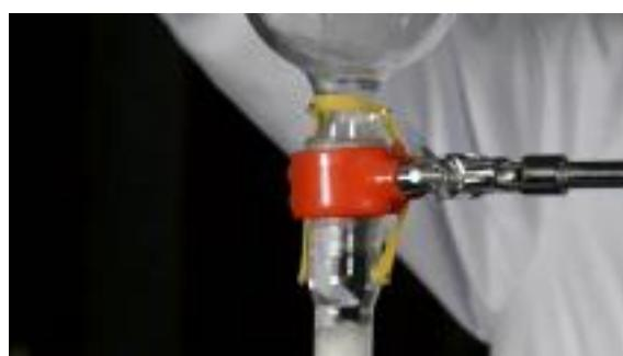
5. 过柱和收集：配制流动相（展开剂，石油醚：乙酸乙酯=3:1），并用淋洗层析柱。用试管收集从层析柱流出的液体，每个试管约 10 毫升。
